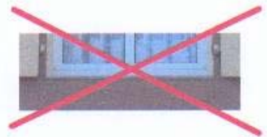
Nicht zulässige Ausbildung der Fensterbänke z.B. in Blech oder mit dünnen Steinplatten
